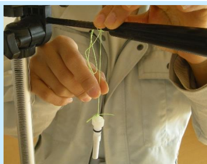
⑥ 天井・照明器具・三脚等に結び付けます。サンプラーを部屋の中央、床上1.2~1.5mの高さに設置します。(認証保育所・保育施設：乳児対象は床上30cm、3歳児対象は床上60cm)
