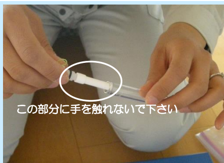
⑤ キャップを持ち、 白い部分に触れないように 容器から取り出します。
